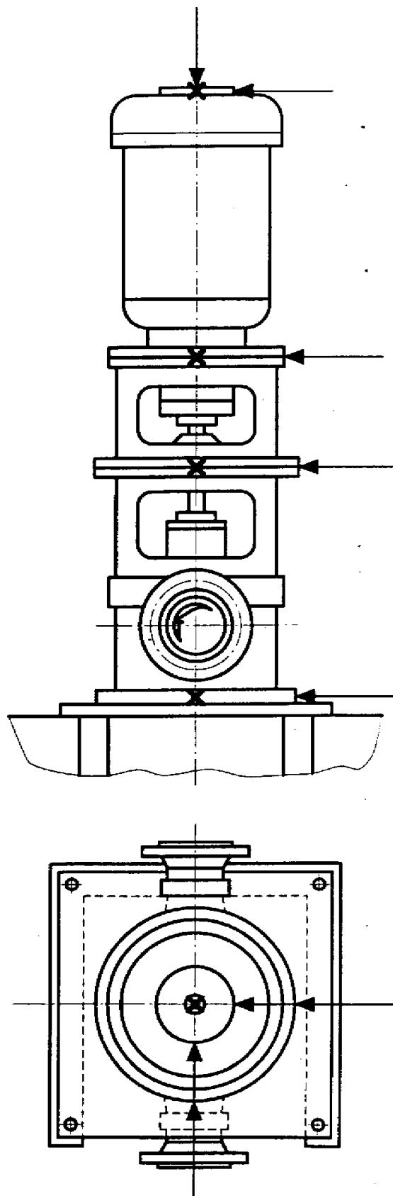
Рисунок 2 — Точки измерений для вертикально установленной машины
