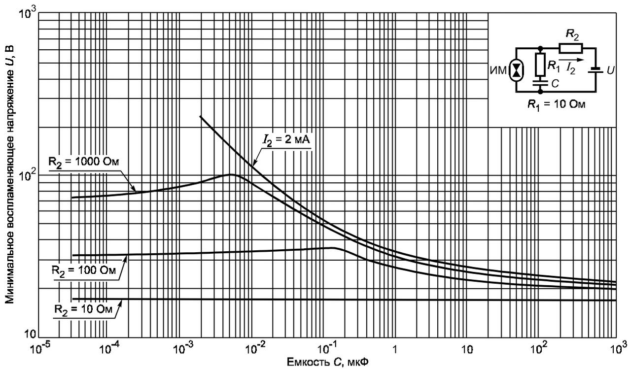
Рисунок А.13 — Минимальное воспламеняющее напряжение в активизированной взрывоопасной водородно-кислородной смеси (81 %  $H_2$  + 19 %  $O_2$ ) для емкостных цепей подгруппы ПА при  $R_1 = 10 \text{ Ом}$
