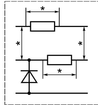
Применяют требования, соответствующие пункту 3 таблицы 4. Минимальная толщина до свободной поверхности — 1 мм.
