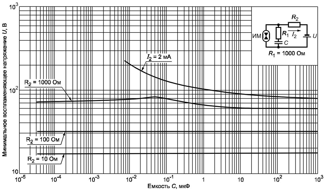
Рисунок А.15 — Минимальное воспламеняющее напряжение в активизированной взрывоопасной водородно-кислородной смеси (81 %  $H_2$  + 19 %  $O_2$ ) для емкостных цепей подгруппы IIA при  $R_1 = 1000 \text{ Ом}$
