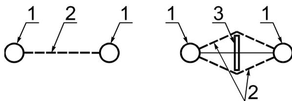
1 — проводник; 2 — зазор; 3 — перегородка
