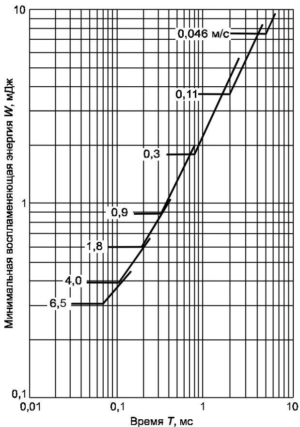
Рисунок А.21 — Минимальная воспламеняющая энергия пропановоздушной смеси (5,3 %  $C_3H_8$  + 94,7 % воздух) в зависимости от длительности разряда и скорости размыкания контактов цепи для подгруппы IIIA
