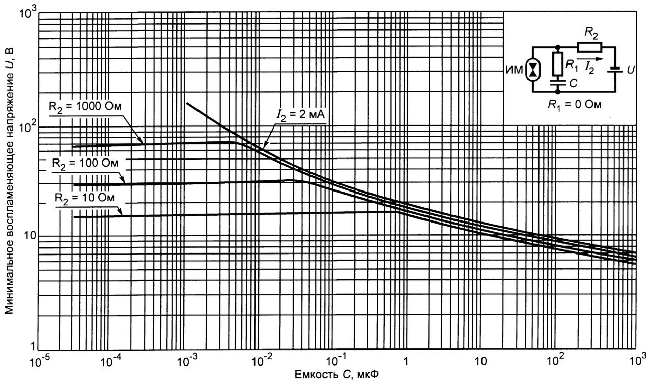
Рисунок А.16 — Минимальное воспламеняющее напряжение в активизированной взрывоопасной водородно-кислородной смеси (75 %  $H_2$  + 25 %  $O_2$ ) для емкостных цепей подгруппы IIB при  $R_1 = 0 \text{ Ом}$
