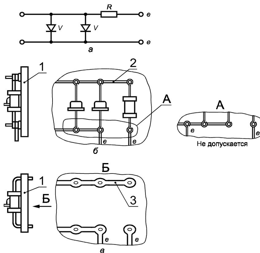
*a* — электрическая схема; *б* — навесной монтаж; *в* — печатный монтаж;
