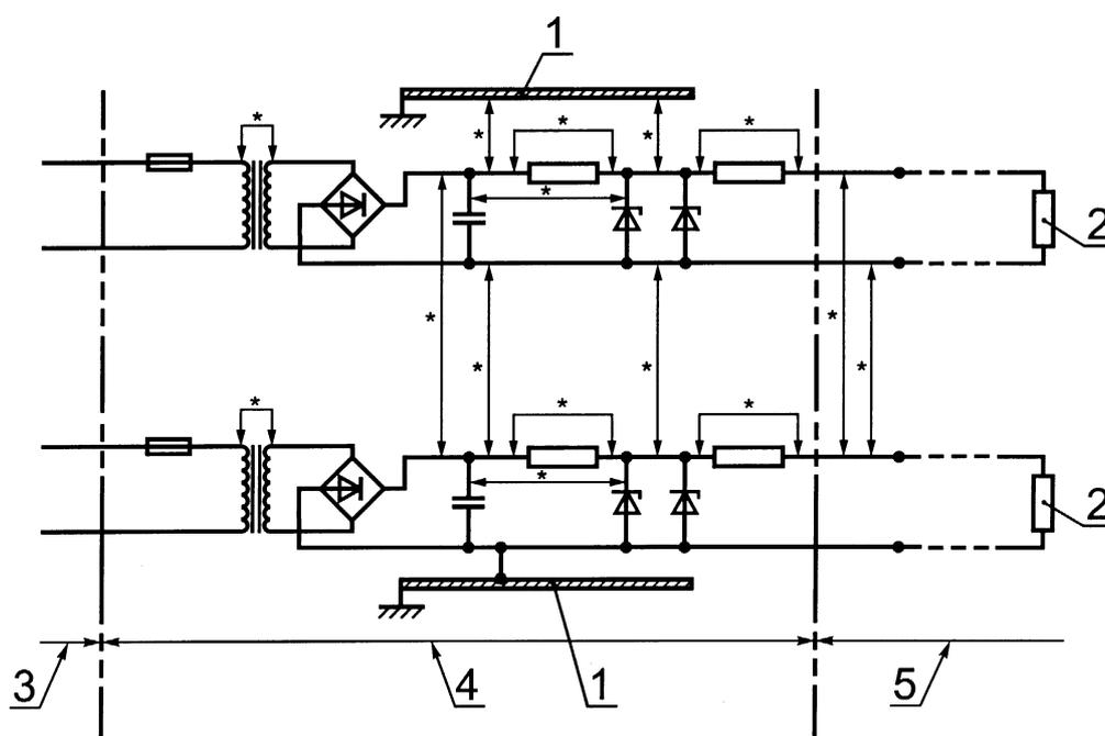
1 — шасси; 2 — нагрузка; 3 — искроопасная цепь, заданная  $U_m$ ; 4 — часть искробезопасной цепи, не являющаяся искробезопасной; 5 — искробезопасная цепь; \* — расстояния разделения, в отношении которых применяется таблица 4
