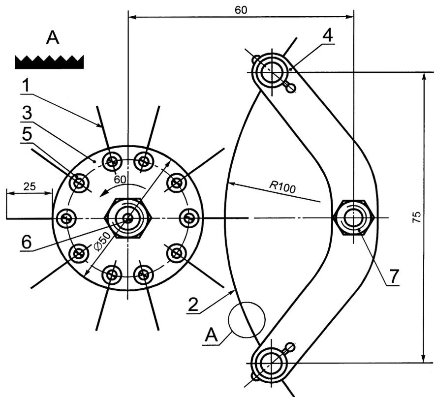
1 — подвижный контакт; 2 — неподвижный контакт; 3 — диск подвижного контакта; 4 — пластина неподвижного контакта; 5 — крепежный болт подвижного контакта; 6 — вращающийся вал подвижного контакта; 7 — крепежная стойка неподвижного контакта
