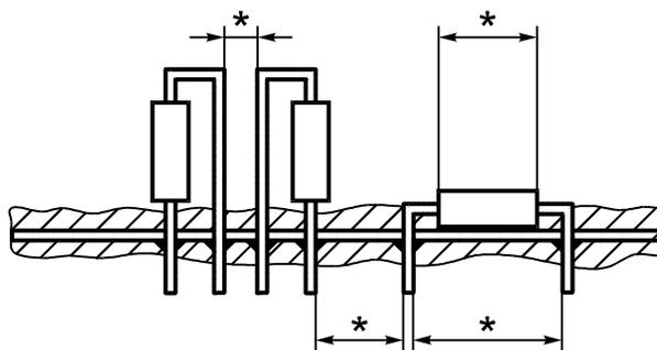
Выводы резистора не герметизированы в пределах покрытия, поэтому для всех размеров, отмеченных знаком \*, применимы требования 6.4.3 и 6.4.7
