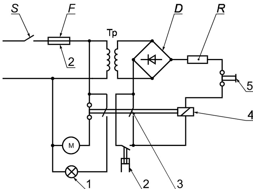
*S* — выключатель; *F* — предохранитель; *Tr* — трансформатор; *D* — диодный выпрямительный мост; *R* — резистор; *M* — приводной двигатель; *1* — сигнальная лампа; *2* — датчик давления; *3* — удерживающий контакт; *4* — реле; *5* — кнопка сброса
