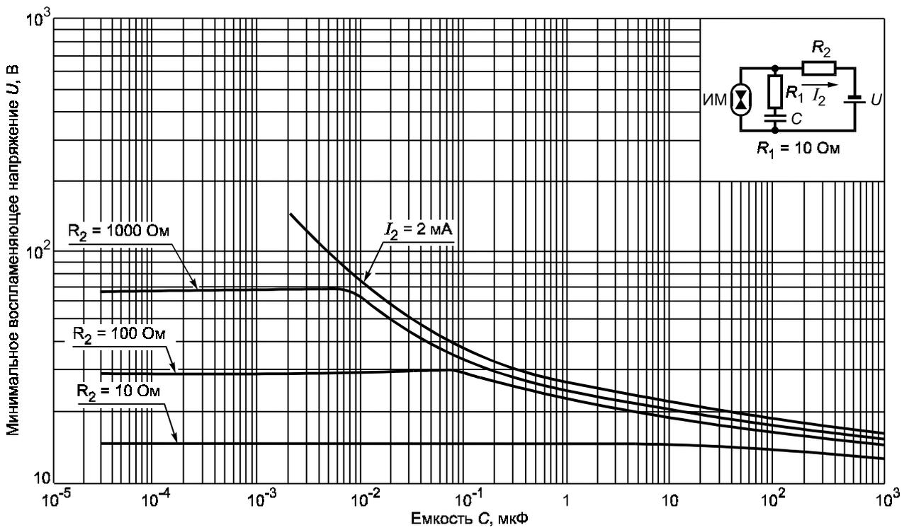
Рисунок А.17 — Минимальное воспламеняющее напряжение в активизированной взрывоопасной водородно-кислородной смеси (75 %  $H_2$  + 25 %  $O_2$ ) для емкостных цепей подгруппы ПВ при  $R_1 = 10 \text{ Ом}$
