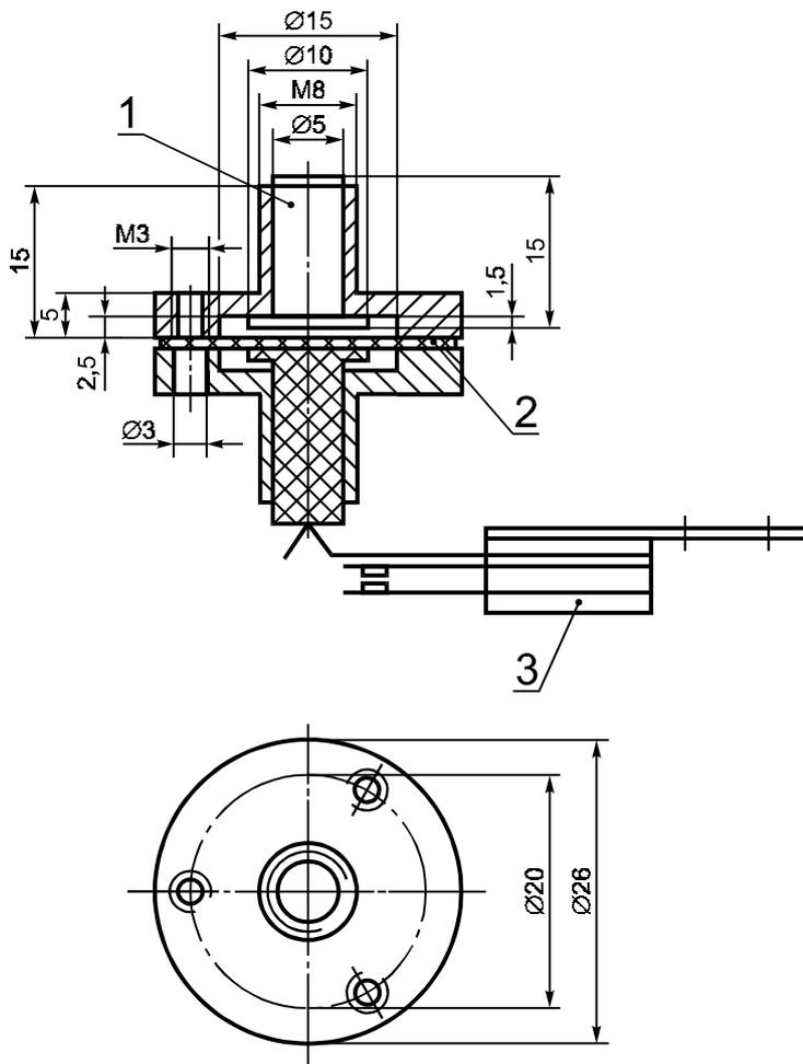
1 — металлический поршень; 2 — резиновая диафрагма; 3 — пружинный контакт
