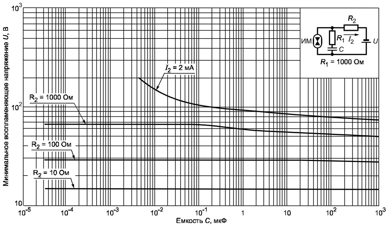
Рисунок А.19 — Минимальное воспламеняющее напряжение в активизированной взрывоопасной водородно-кислородной смеси (75 %  $H_2$  + 25 %  $O_2$ ) для емкостных цепей подгруппы ИВ при  $R_1 = 1000 \text{ Ом}$
