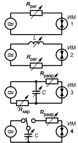
1 — омическая цепь; 2 — индуктивная цепь; 3 — емкостная цепь без отключения емкости; 4 — емкостная цепь с отключением емкости;  $R_{\text{рег}}$  — резистор для регулировки тока в цепи;  $R_{\text{зар}}$  — резистор для заряда емкости;  $R_{\text{разр}}$  — разрядный резистор; ИМ — искрообразующий механизм;  $I$  — воспламеняющий ток;  $U$  — воспламеняющее напряжение
