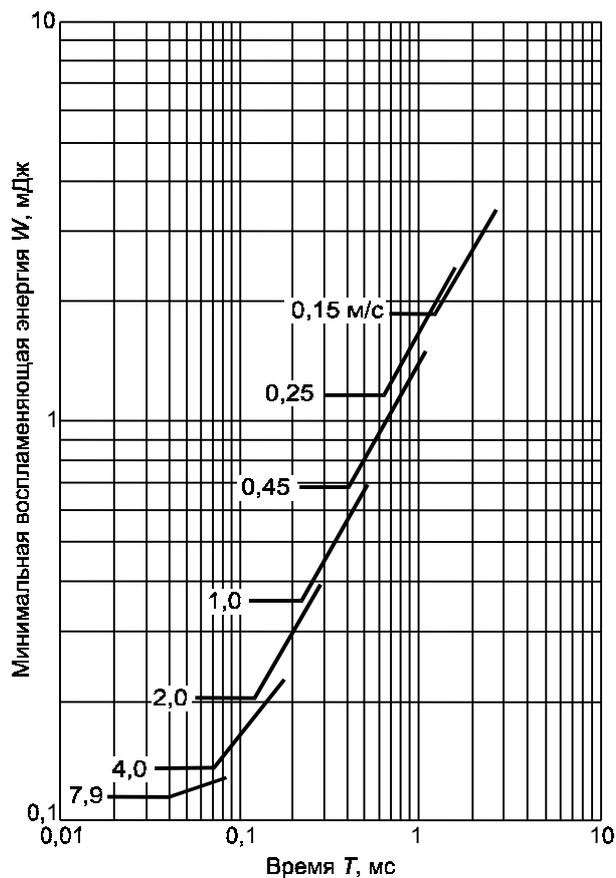
Рисунок А.22 — Минимальная воспламеняющая энергия этиленовоздушной смеси (7,3 %  $C_2H_4$  + 92,7 % воздух) в зависимости от длительности разряда и скорости размыкания контактов цепи для подгруппы IIIB
