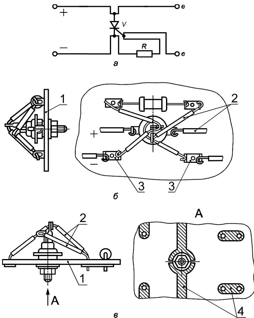
*a* — электрическая схема; *б* — навесной монтаж; *в* — печатный монтаж; *V* — шунтирующий тиристор; *R* — токоограничительный резистор; *e* — к искробезопасной цепи (шунтирующему элементу); *1* — панель; *2* — провод; *3* — лепесток; *4* — печатный проводник
