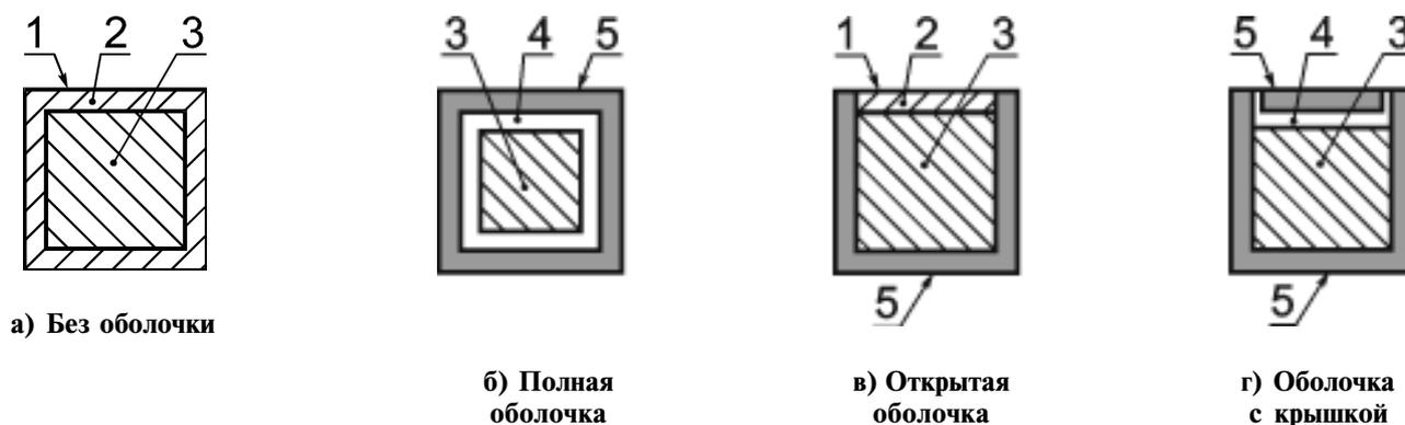
1 — свободная поверхность; 2 — герметизация; половина значения из пункта 3 таблицы 4 при минимальном значении 1 мм; 3 — компонент, герметизирующий материал не должен проникать; 4 — герметизирующий материал, толщина не задана; 5 — металлическая или изоляционная оболочка; для металлической оболочки толщину не указывают, (см. 6.4), для изоляционной оболочки толщина изоляции должна соответствовать значению пункта 4 таблицы 4
