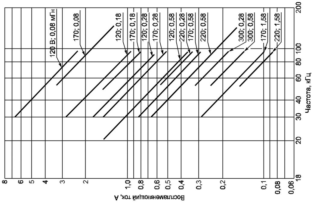
Рисунок AI.15— Зависимость воспламеняющегося тока от частоты, индуктивности и напряжения источника для метановоздушной смеси
