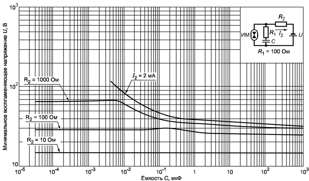
Рисунок А.18 — Минимальное воспламеняющее напряжение в активизированной взрывоопасной водородно-кислородной смеси (75 %  $H_2$  + 25 %  $O_2$ ) для емкостных цепей подгруппы ПВ при  $R_1 = 100 \text{ Ом}$
