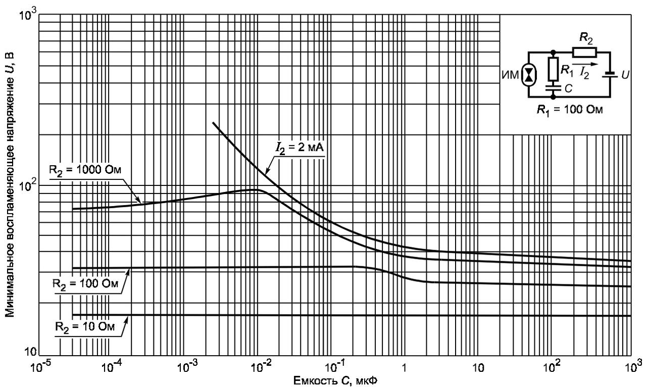
Рисунок А.14 — Минимальное воспламеняющее напряжение в активизированной взрывоопасной водородно-кислородной смеси (81 %  $H_2$  + 19 %  $O_2$ ) для емкостных цепей подгруппы ПА при  $R_1 = 100 \text{ Ом}$
